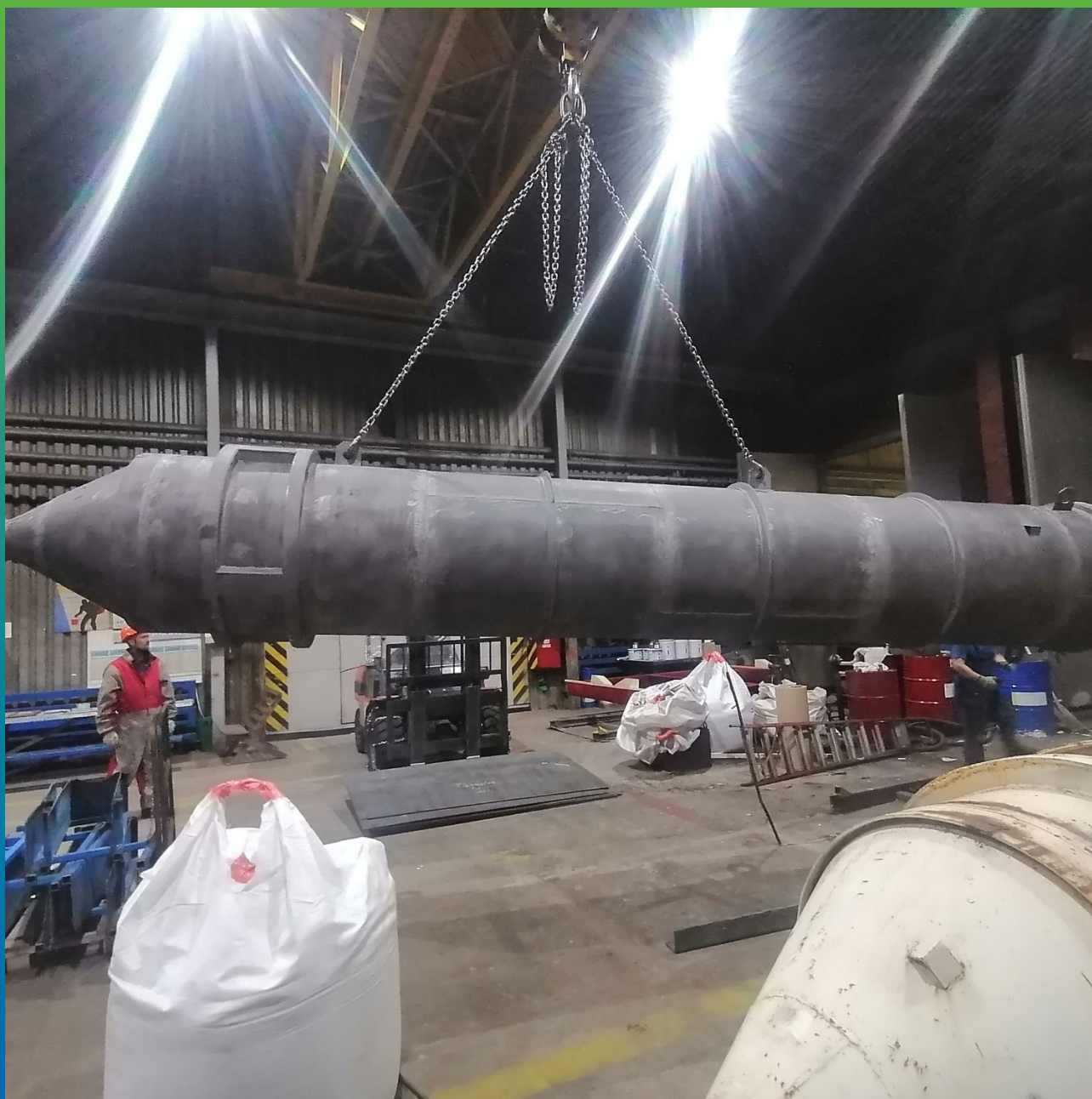
Вид после пескоструйной обработки
