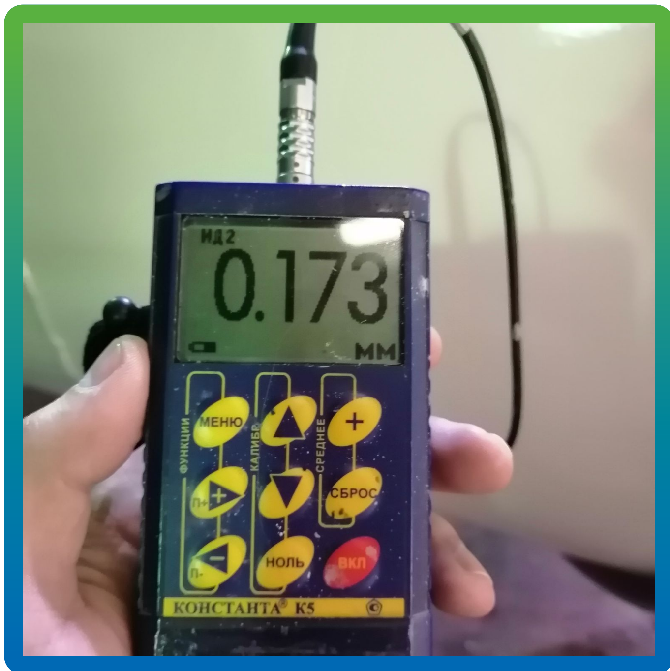
Контроль качества, замер толщины сухой пленки промежуточного слоя
