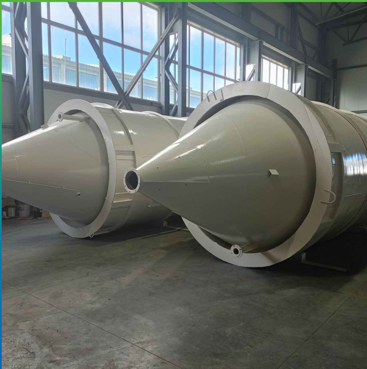
Вид системы покрытий ДенсТоп ПУ 113 + ДенсТоп ПУ 302 после полимеризации на силосах большего диаметра
