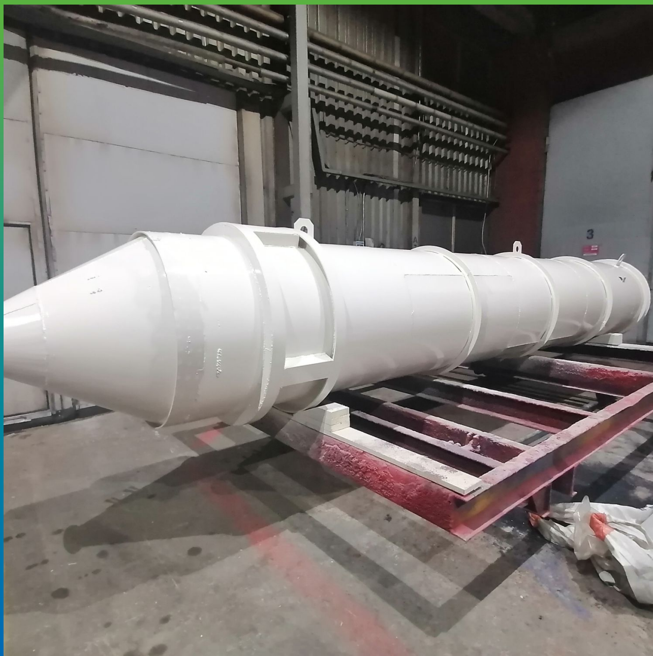
Финишный вид, после нанесения 3 финишного слоя ДенТоп ПУ 302
