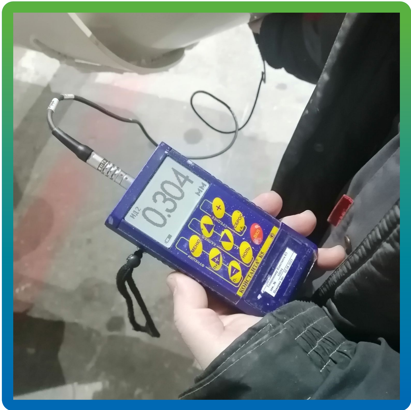
Контроль качества системы антикоррозионного полиуретанового покрытия ДенТоп ПУ 113 + ДенТоп ПУ 302
