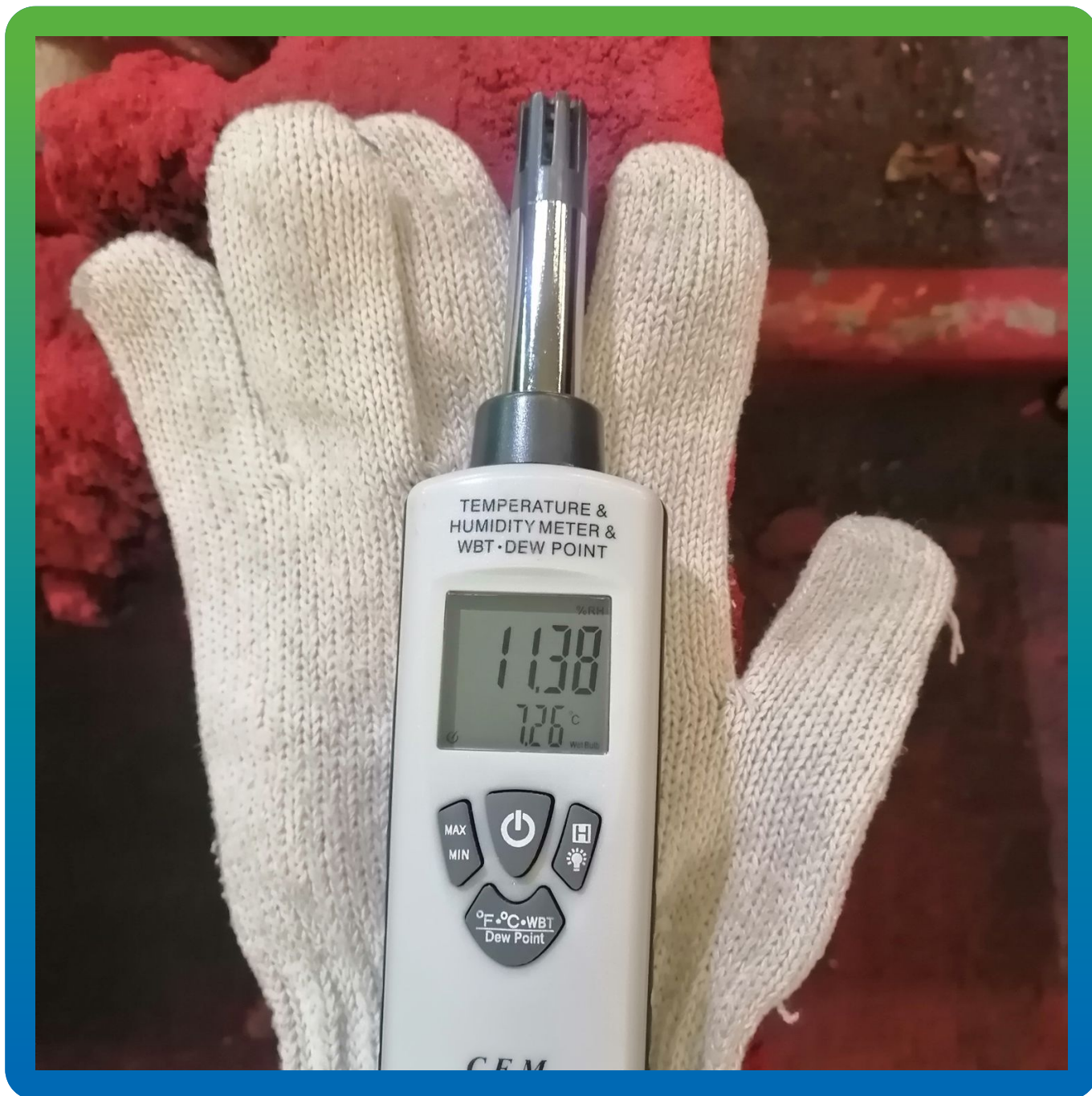
Замер температуры в покрасочной камере
