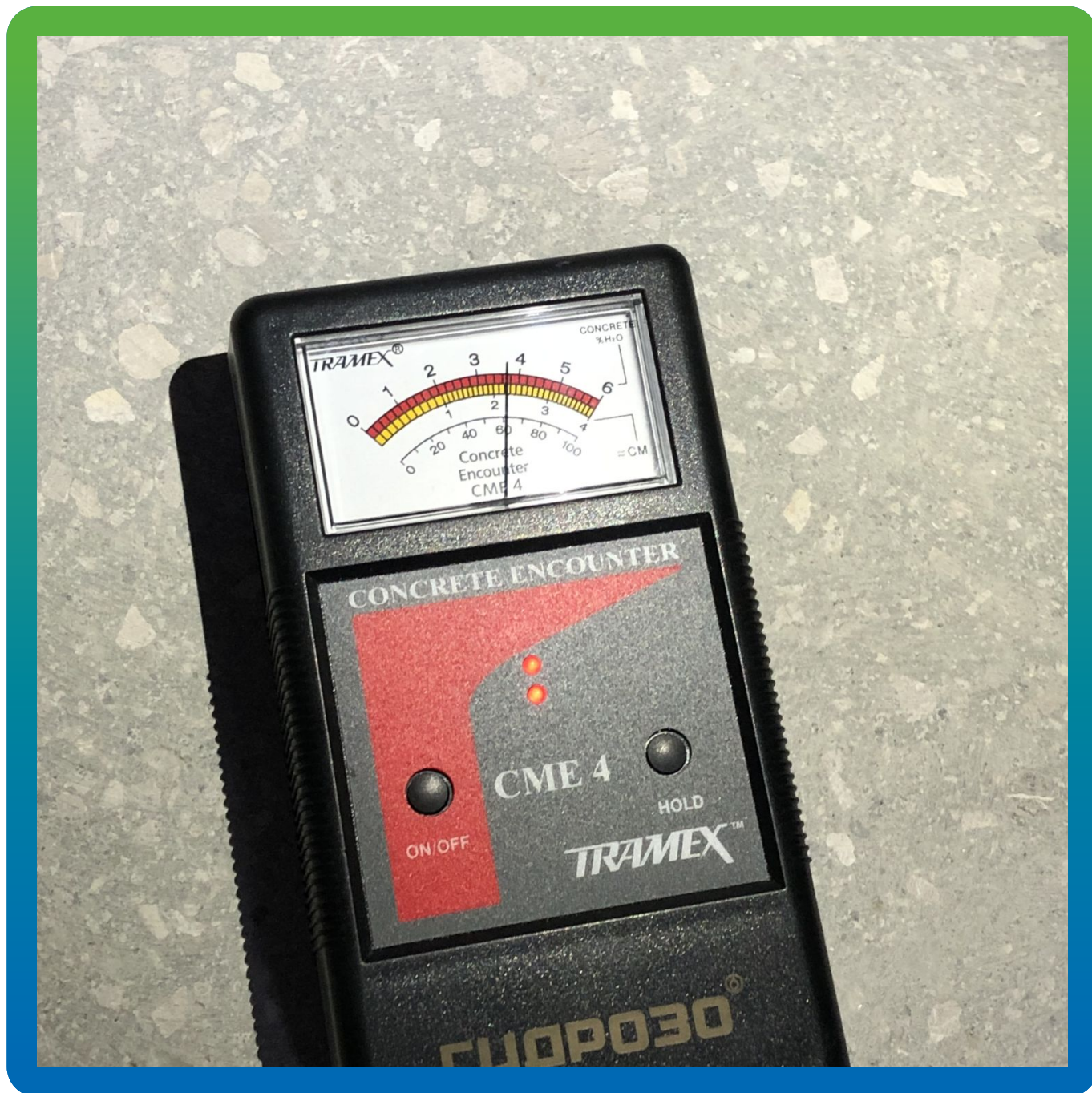
Проверка влажности основания
