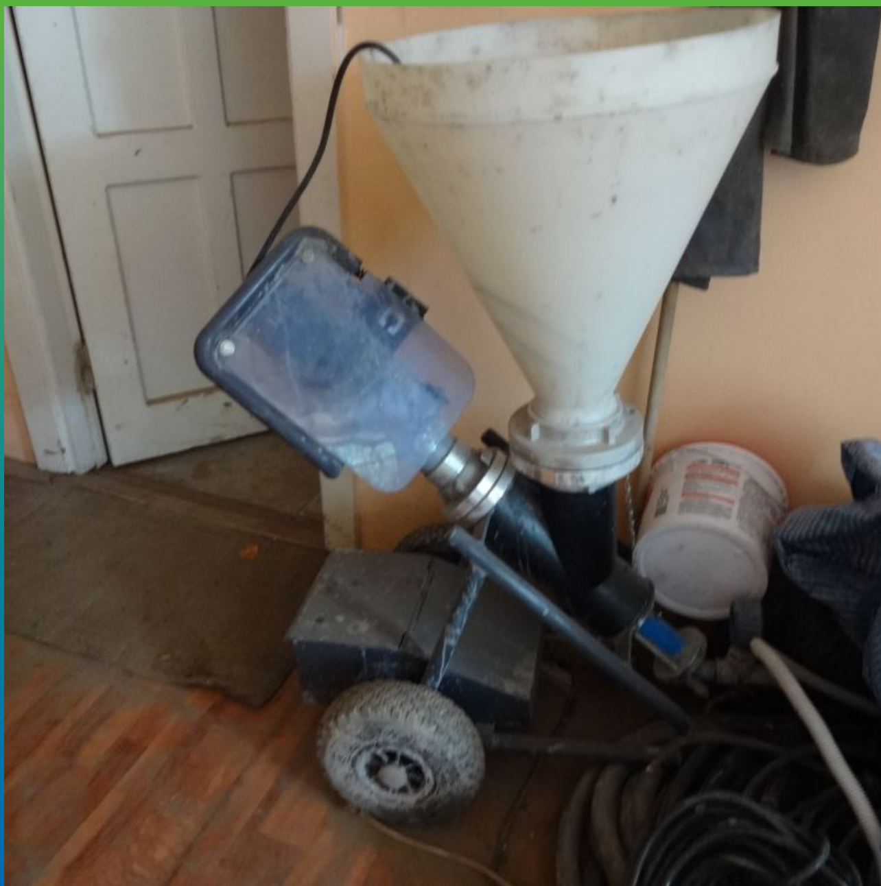
Шнековый насос БМП 6 на объекте
