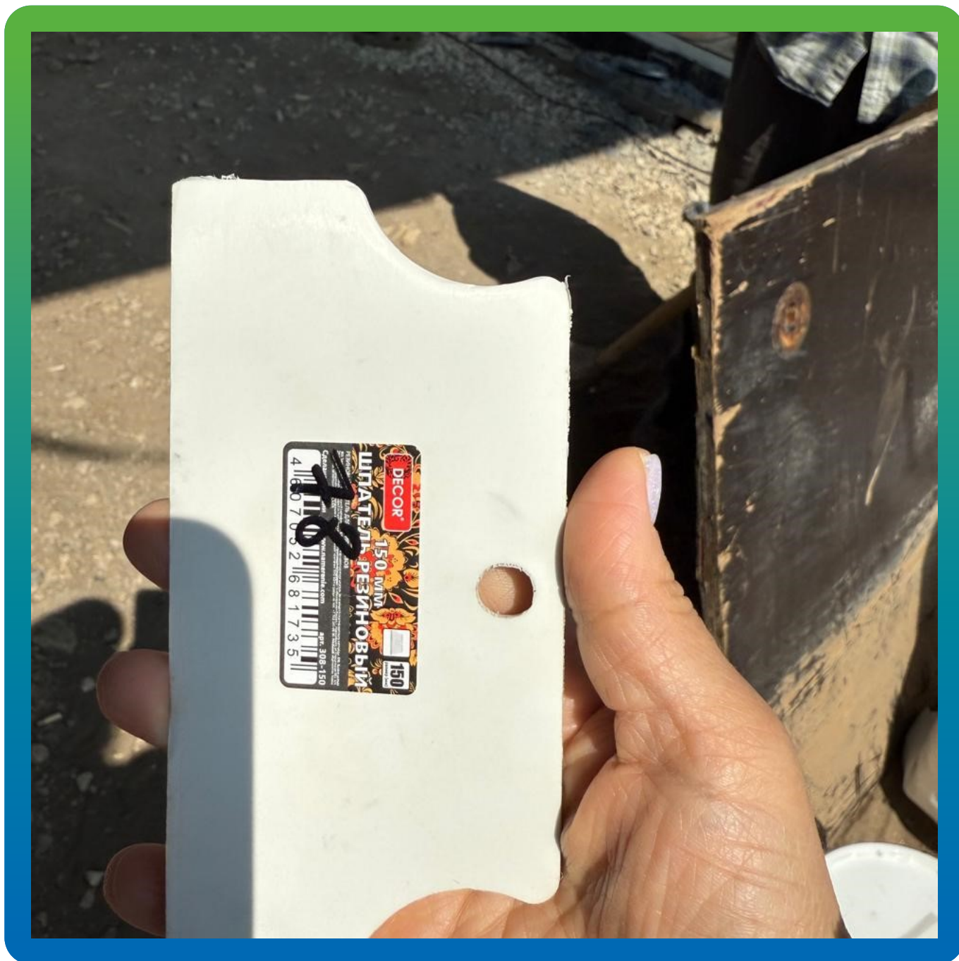
Резиновый шпатель для нанесения клея и разравнивания холста на поверхности опоры
