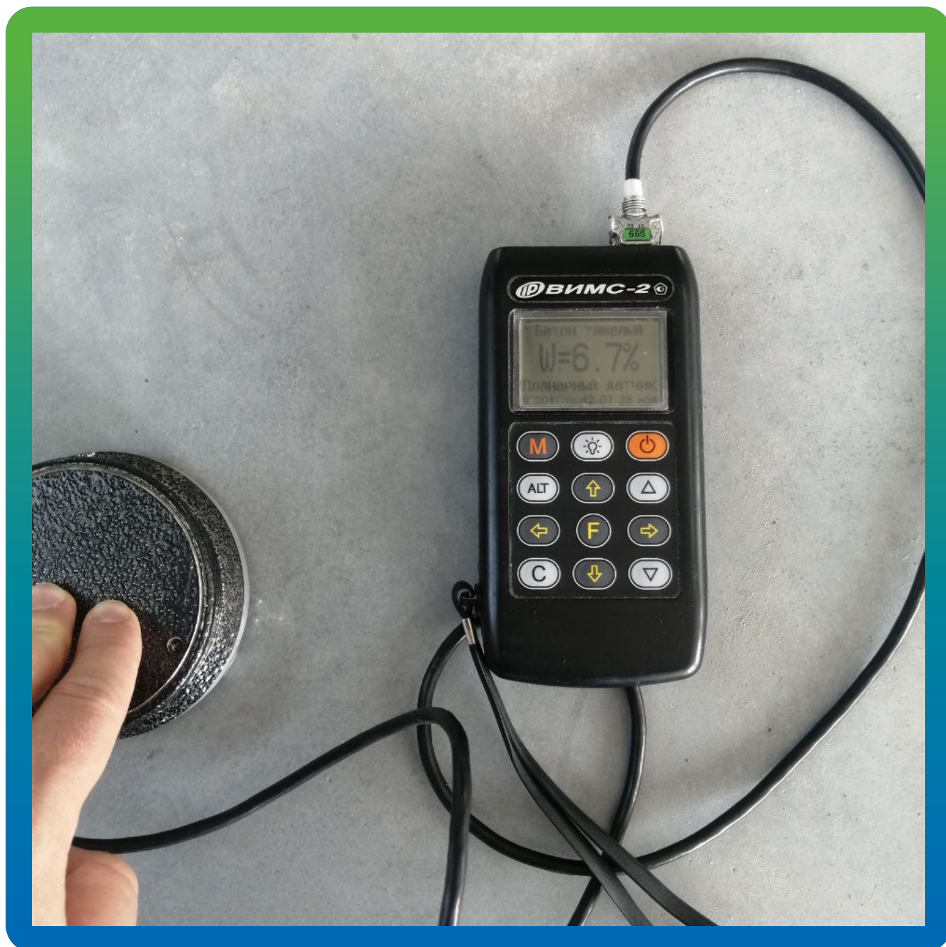
Инструментальная проверка влажности бетона
