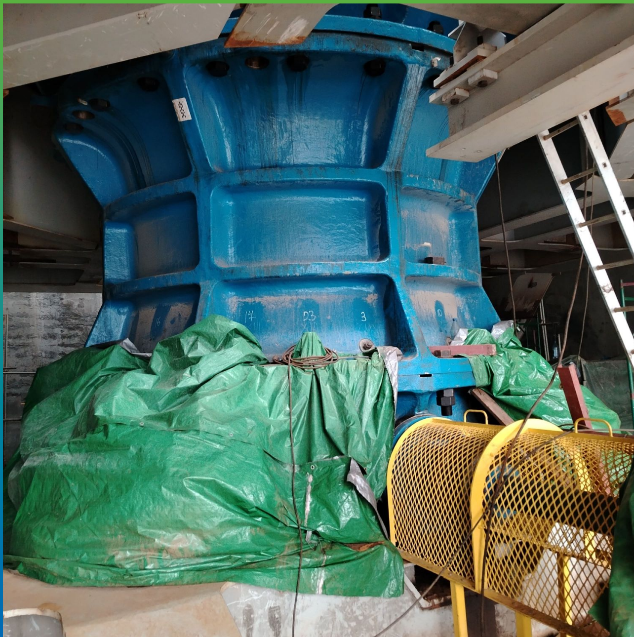
Корпус агрегата для измельчения минерального сырья
