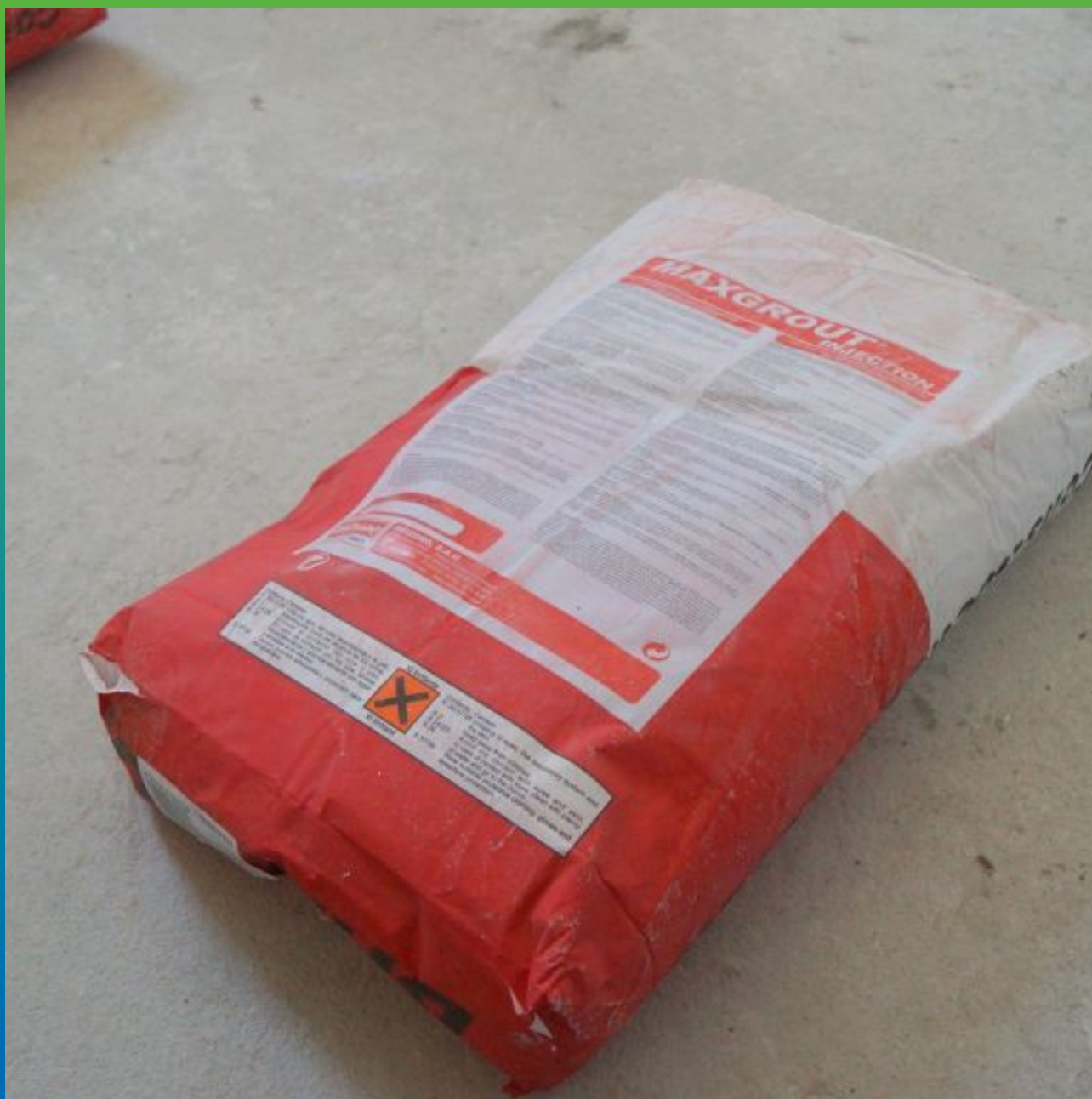
Микроцементный состав "Максгрут Инжекшн" на объекте. Общий вид материала.
