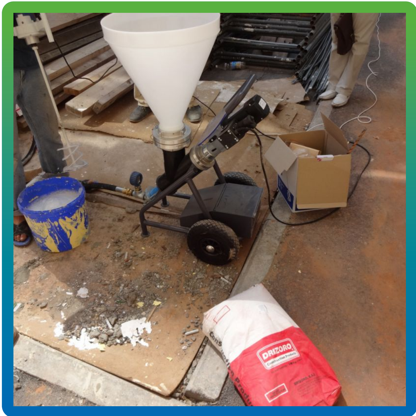
Первый запуск шнекового насоса БМП-6 с мыльным раствором
