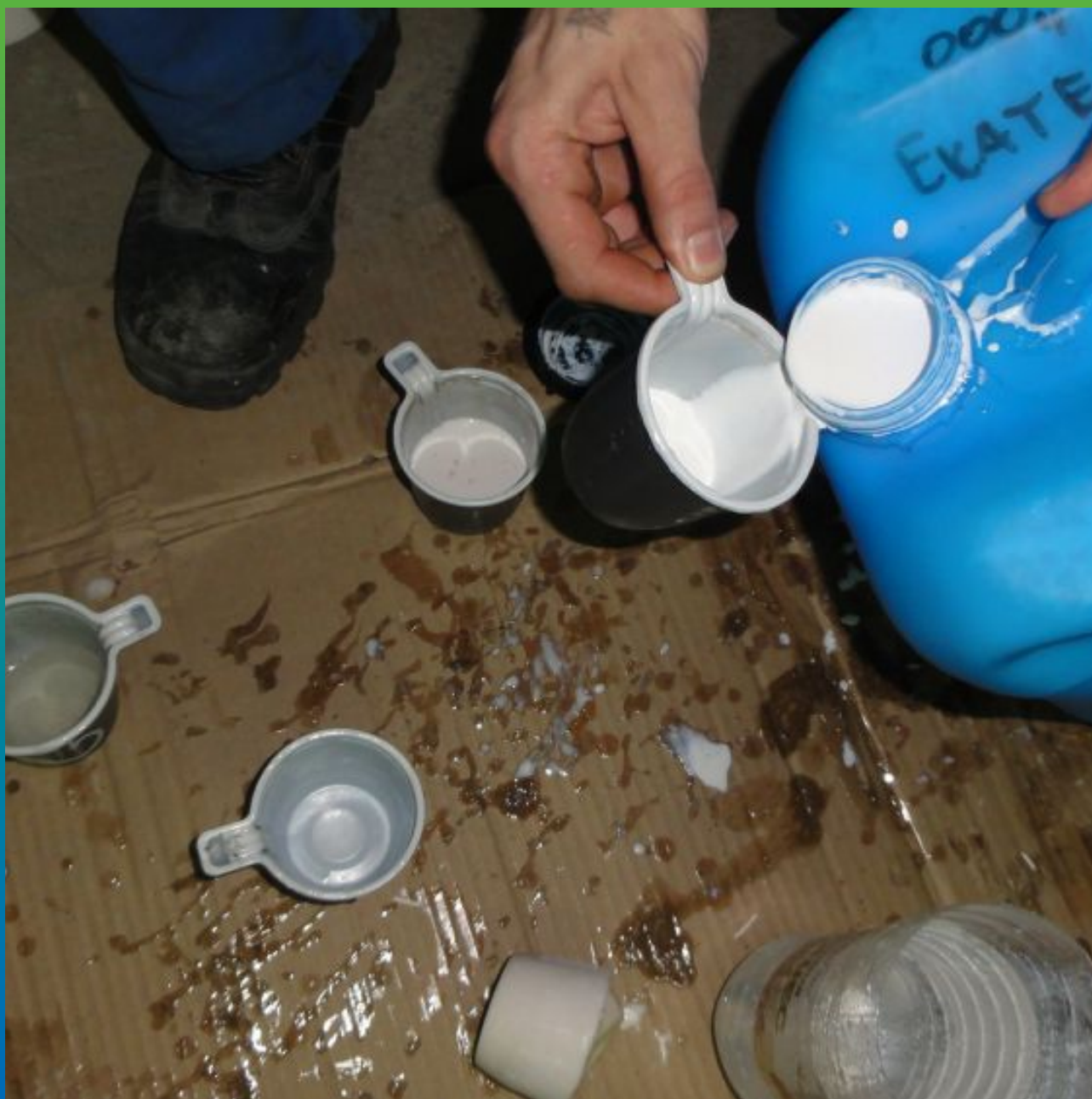
Регулировка времени реакции состава, путем добавления компонента Б в Витракрил Флекс Тикс
