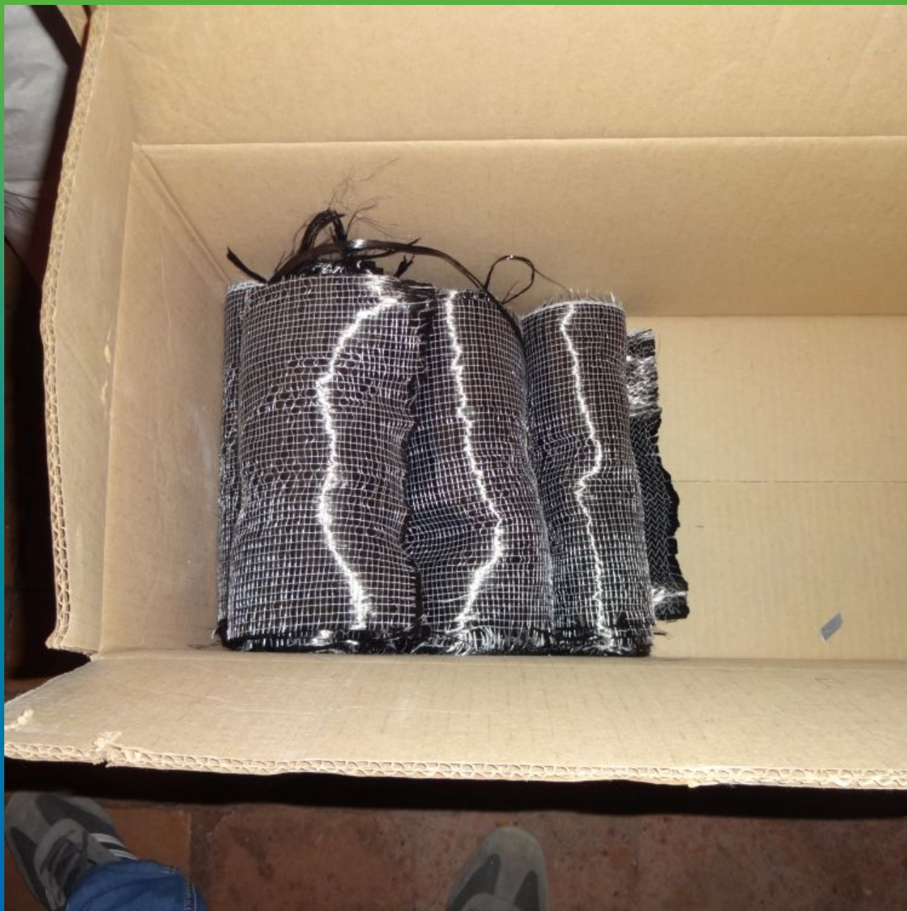
Углеродный композиционный материал Армошел 500 на объекте
