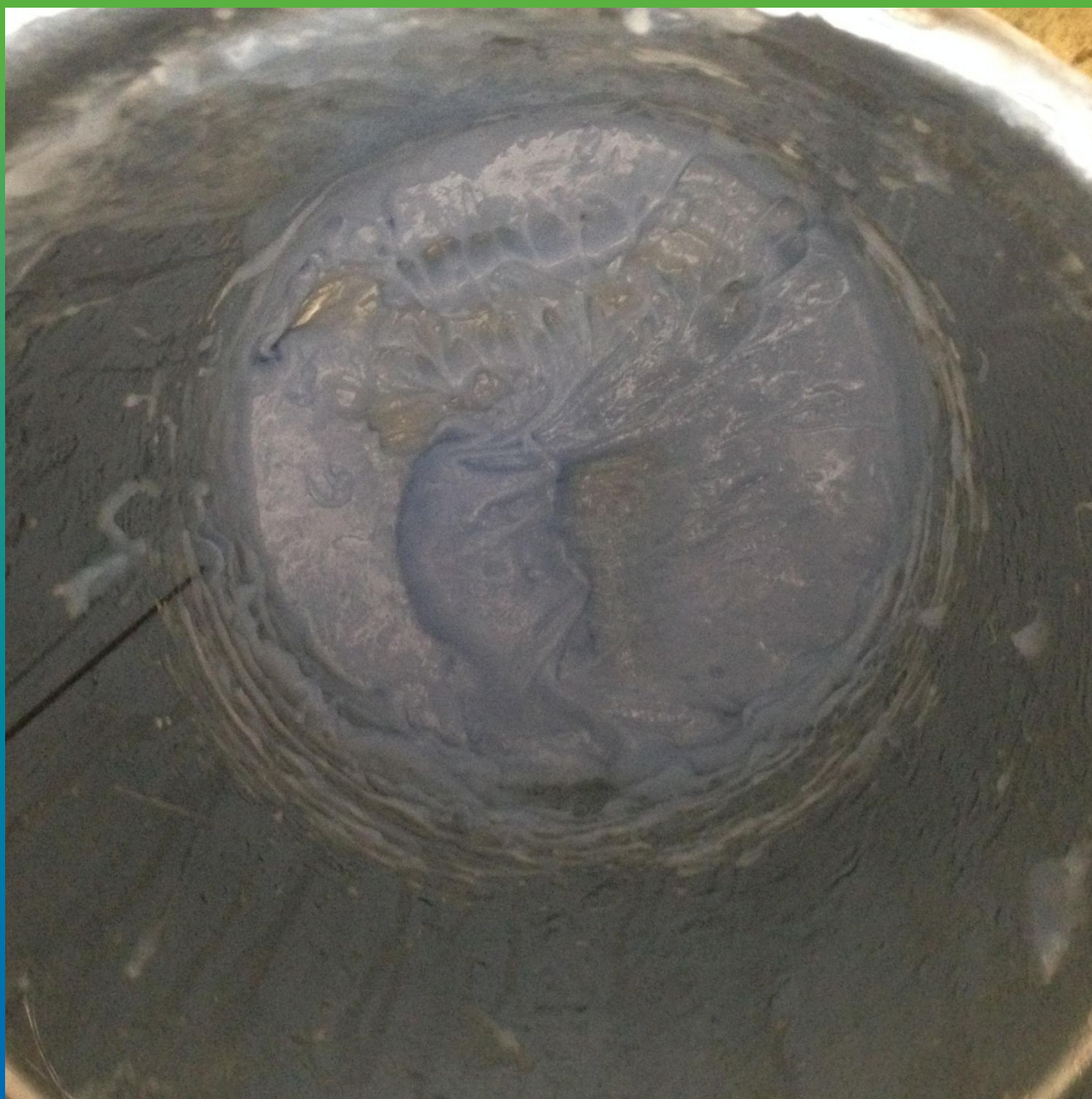
Подготовка материала. Загущение Манопокс 372 с помощью Манопокс Тикс
