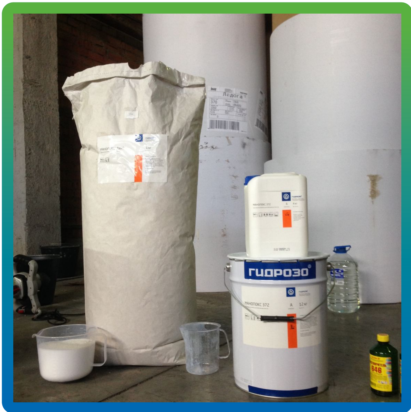
Материалы на рабочем месте. Клей Манопокс 372 и загуститель Манопокс Тикс
