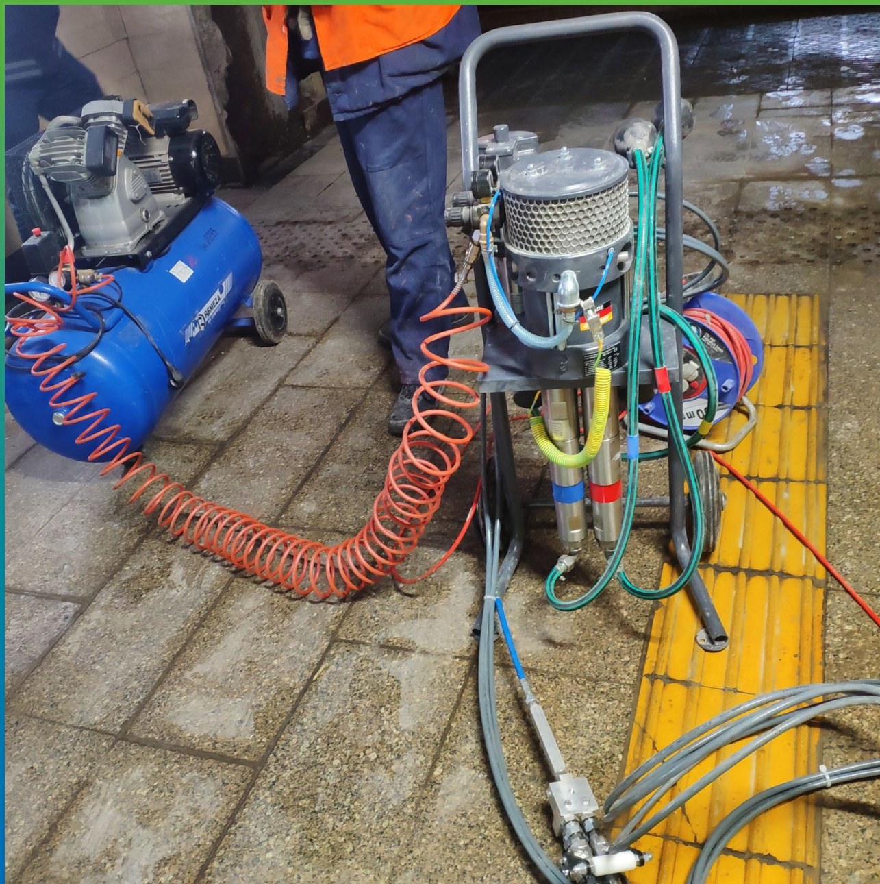
Оборудование для прокачки шва - пневматический поршневой насос БМ 1425.
