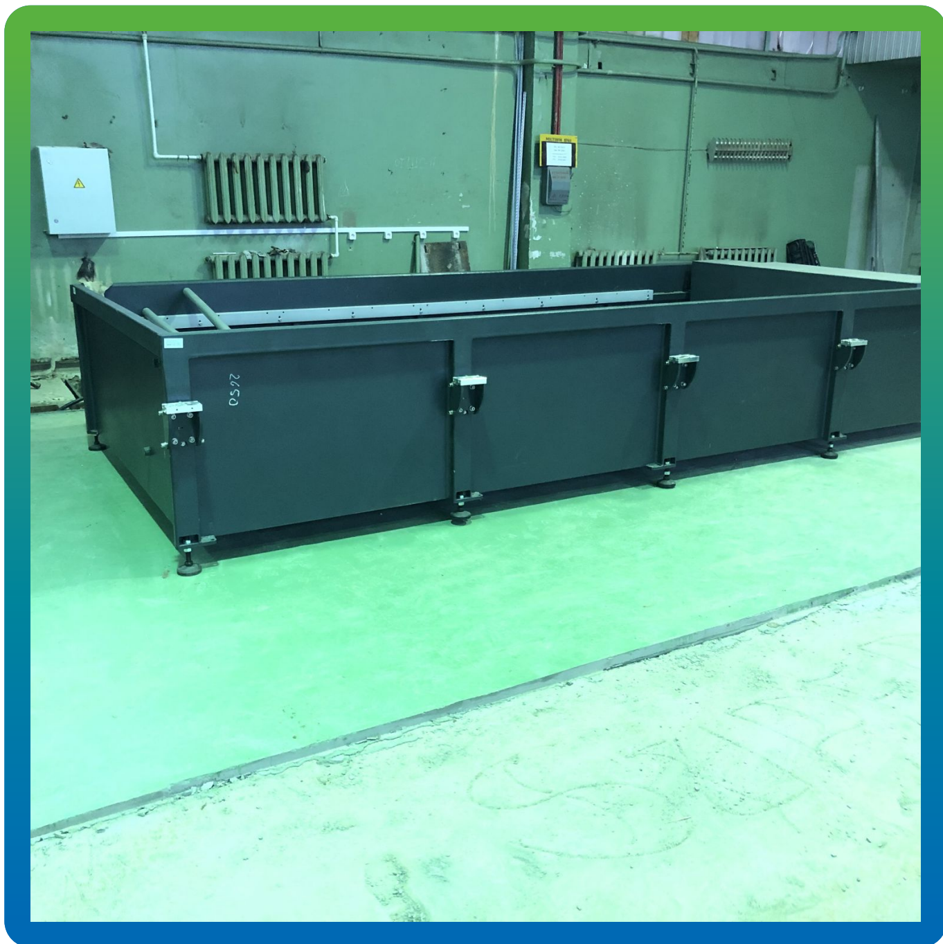
Установка гидроабразивной резки
