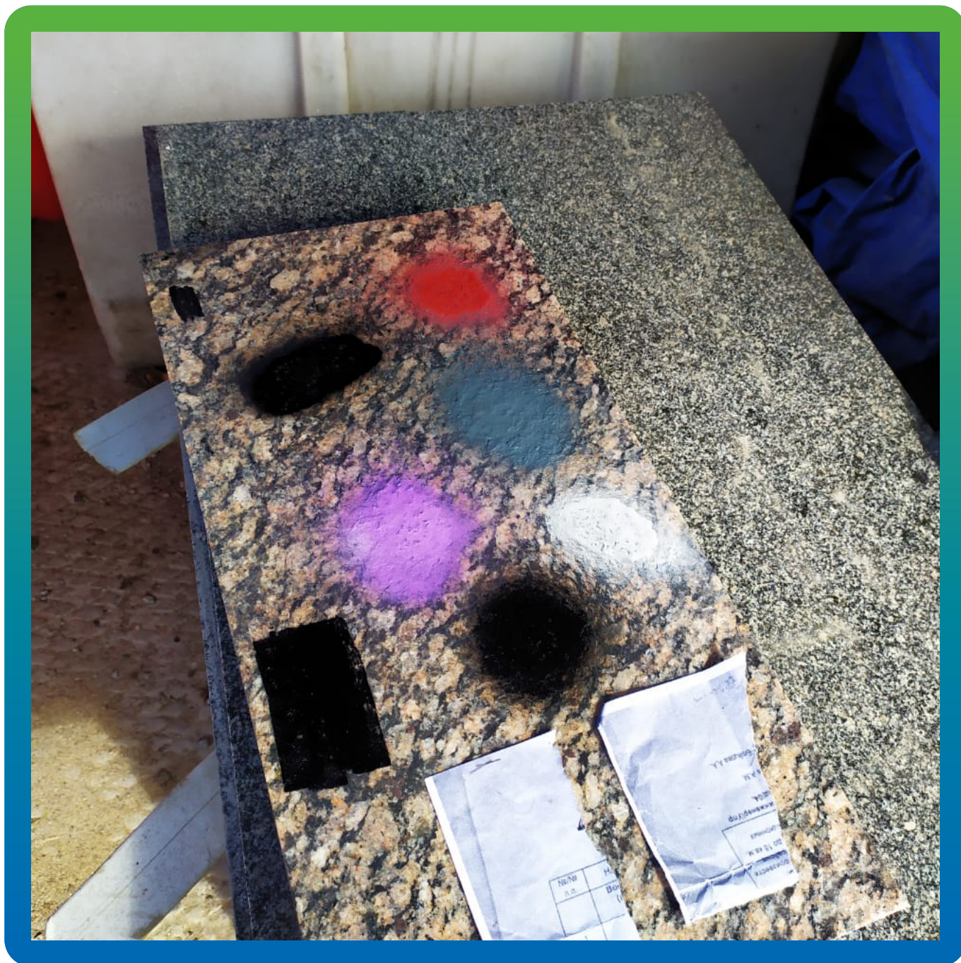
Тестирование антивандального покрытия Маногард АГФ на объекте. Нанесение окрасочного покрытия на образец.
