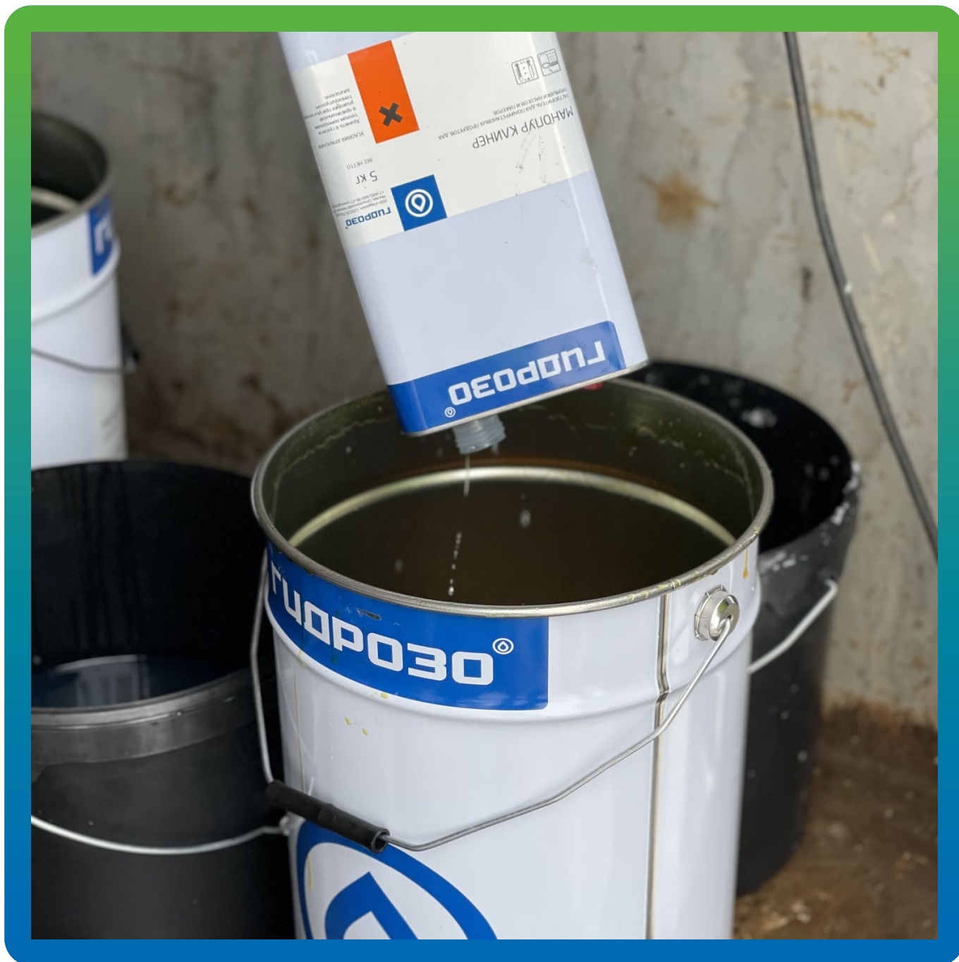
Промывка насоса составом Манопур Клинер
